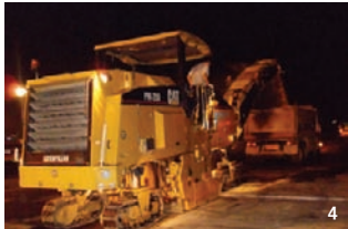
1. 장비를 꼼꼼히 체크하는 김한순 과장과 이기수 상무 2. 김한순 과장이 있어 언제나 든든합니다! 3, 4. 야간 아스팔트 포설 작업 중인 아스팔트파니셔 AP755와 파 쇄 작업 중인 노면 파쇄기 PM200
