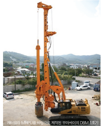
캐터필라 MHPU를 바탕으로 제작된 부마씨의 DBM 1호기
