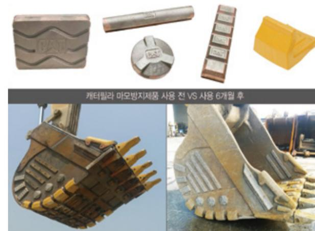
(주)혜인은 버킷을 비롯한 마모가 발생할 수 있는 제품 부위를 마모로부터 보호해주는 캐터필라 마모방지제품을 15% 할인된 가격에 제공한다. 캐터필라 마모방지제품은 다양한 모양과 크기로 제작되어 원하는 부위에 보강할 수 있으며, 한 번의 보강으로도 오랜 수명을 유지시켜줌으로써 장비 운휴시간 및 용접비용을 절감할 수 있는 제품이다. 췁혜인 마케팅팀 이성택 팀장은 "Rc 경도 최소 60 이상(하독스 700급)급 캐터필라 마모방지제품을 굴삭기 버킷에 장착해 6개월간 마모 테스트를 시행해 본 결과 변형 없이 오랜 수명이 유지됨을 확인할 수 있었다."며 "심각한 마모로 버킷 교체 주기가 잦은 현장에 캐터필라 마모방지제품 사용을 적극 추천한다."고 말했다. 캐터필라 마모방지제품 15% 할인 판매는 3월부터 금년 말까지 시행될 예정이다.
